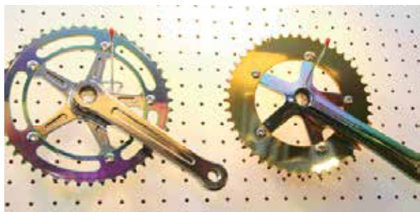
▲五彩陽極處理的單速車曲柄在光線照射下，會反射出五彩顏色。
