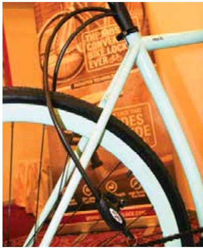
▲interlock是將車鎖的座桿結合一體成型，可將鎖頭與鋼繩由座桿抽出鎖車，不用時則收回座桿中。
