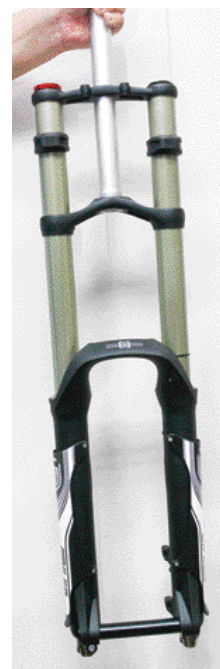
野寶RV1行程200mm的下坡車專用前叉。
