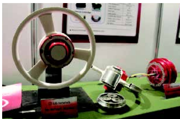
▲LG的高扭力馬達最大扭力可達54Nm，獲得不少買主青睞。
