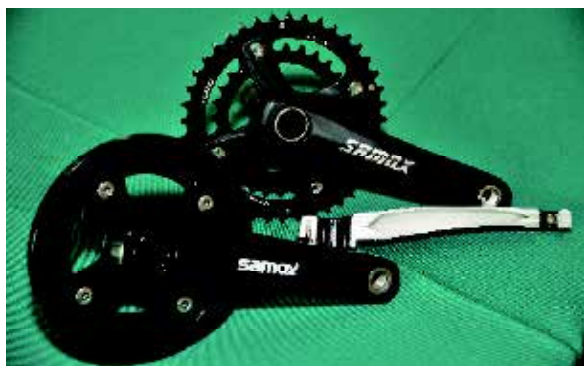
▲Samox推出中空曲柄設計，可以搭配兩盤式 (40/28) 或三盤式 (42/32/24)，並且可以用於10段變速系統，適合XC車款使用。
