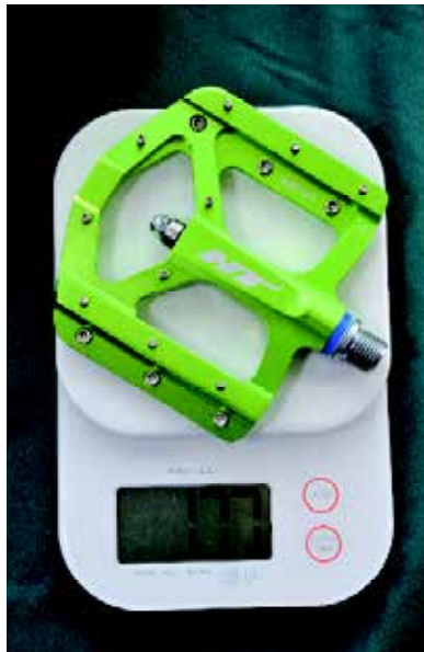
▲HT創新式踏板從兩層式進化到單層式，可以達到輕量化15%，整組重量358g，防鬆螺帽顯露在外側，可以方便維修保養，本款為Downhill車款專用。
