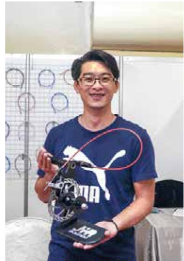
▲安益利鋁合金鍛造卡鉗的機械式卡鉗，擁有高剛性搭配亮麗的外觀，且在煞車手感上趨近於油壓碟煞，讓技術專員王大元對自家產品具有高度信心。
