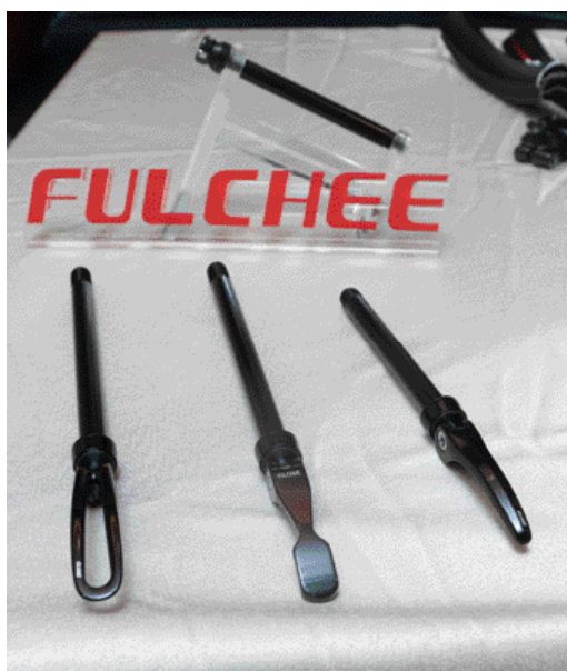
▲富錡Fulchee快拆桿，粗曠快拆把手，採用專利隱藏式結構設計，使用7075鋁合金材質，可客製化軸心、把手尺寸規格。
